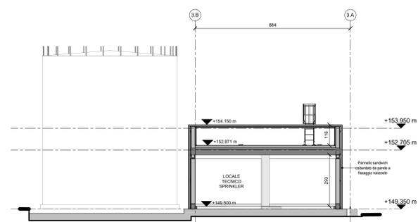
7 SEZIONE EDIFICIO SPRINKLER
