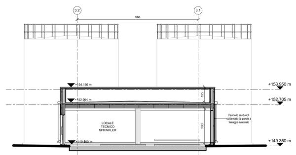
8 SEZIONE EDIFICIO SPRINKLER
