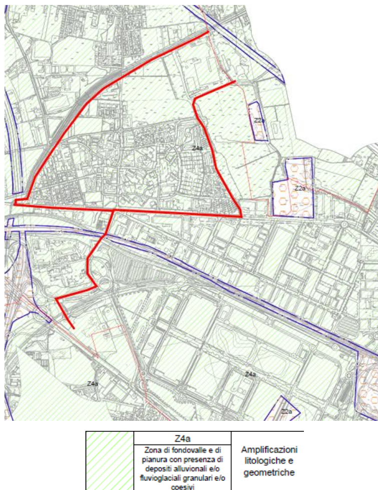
Figura 2-16 Carta della sismica locale -Componente Geologica- comune di Rho (in rosso è indicato l'elettrodotta).
