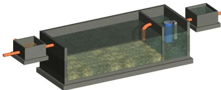
**Figura 20 – Esempio di impianto di prima pioggia in linea**
