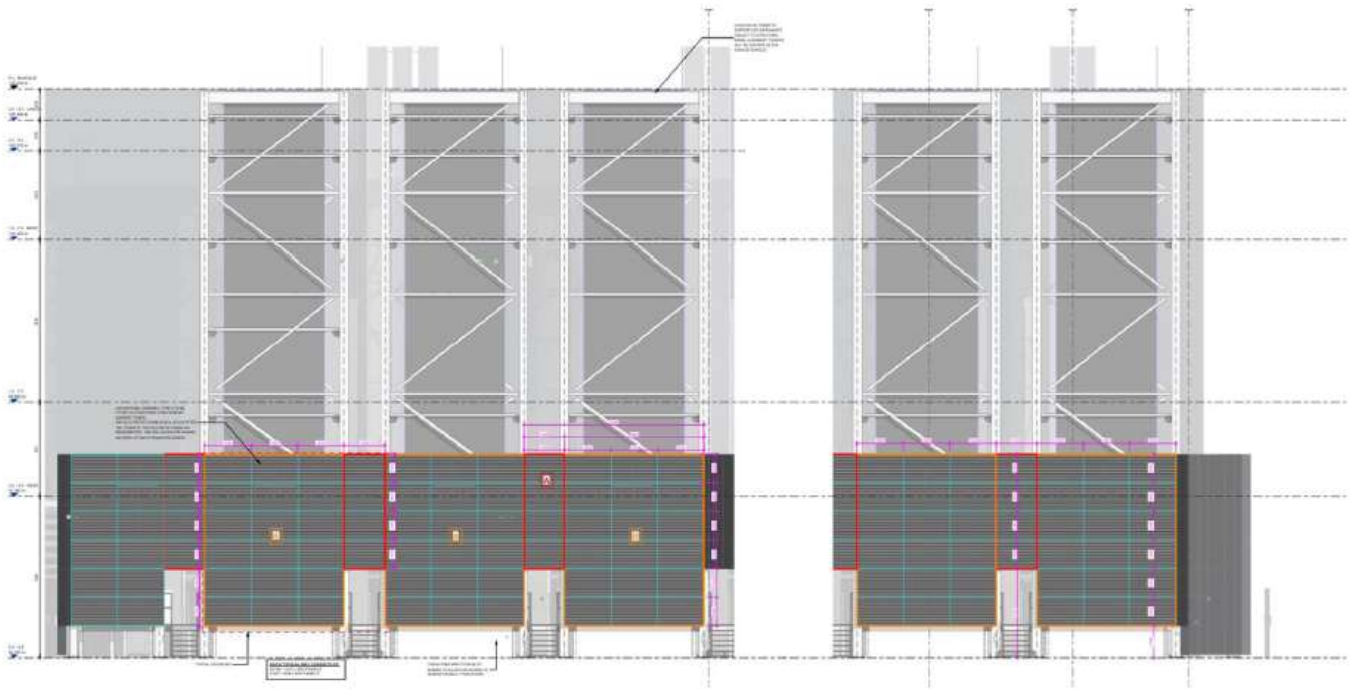
Figure 5.10 Schema generatori e louvres acustici
