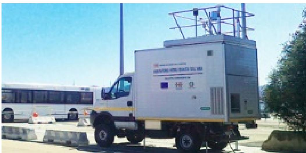
Fig. 5-4: Stazione mobile per il monitoraggio degli inquinanti da traffico veicolare, polveri e microclima
