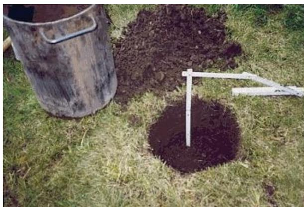
Fig. 6-17: Prova di Permeabilità superficiale
