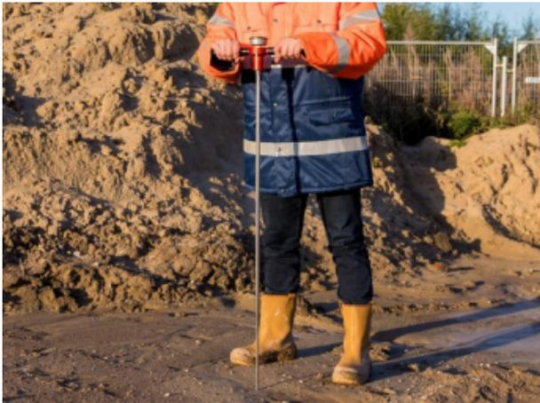
*Fig. 6-14: Penetrometro manuale per la misura della densità in situ*
