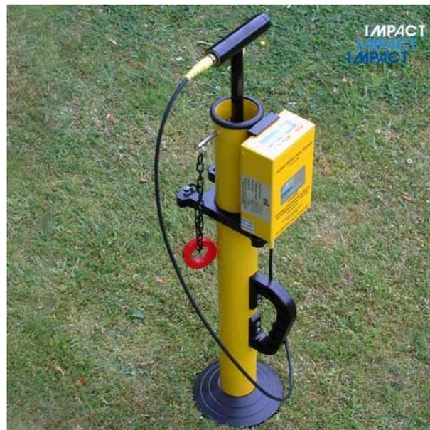
*Fig. 6-16 Strumentazione ad impatto per Slegg Test*
