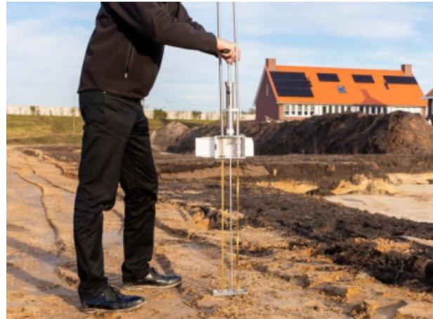
*Fig. 6-15: Penetrografo manuale per misure di compattazione del terreno*
