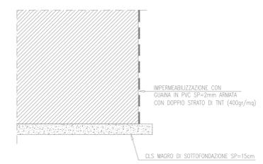
DETTAGLIO GIUNTO STRUTTURALE TIPOLOGICO
