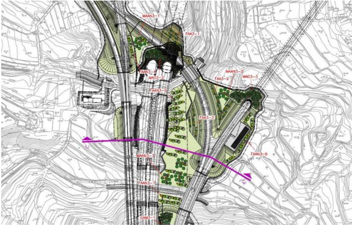
Figura 50. Modellazione morfologica e quinte visive degli ingressi in galleria ramo D, lato Calabria
