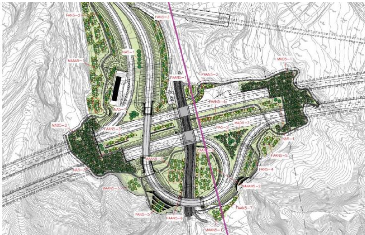
Figura 51 Dettaglio di sistemazione morfologica e quinte vegetali di uno svincolo, lato Sicilia
