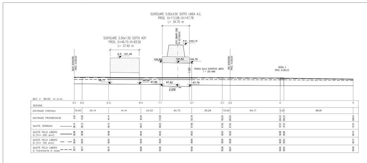
VASO BRANDINA (PK 82+999.00) - SISTEMAZIONE IDRAULICA SEZIONE SCATOLARE 5.00x3.00 IN ASSE LINEA A.C. - Scala 1:50
