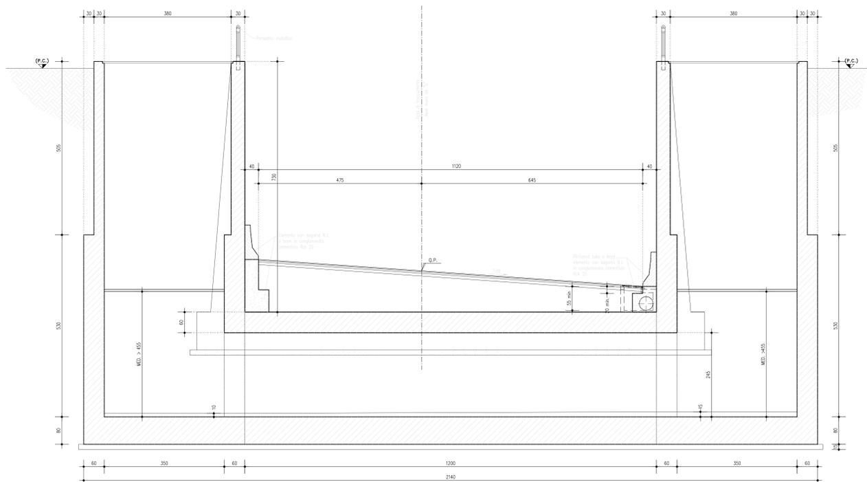
PARTICOLARE IMPERMEABILIZZAZIONE SOLETTA DI FONDAZIONE MURI E POZZETTO ISPEZIONE RETE DI SCOLO ACQUE METEORICHE 1:20
