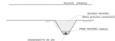
PARTICOLARE DI POSIZIONAMENTO TUBI PORTACAVO
