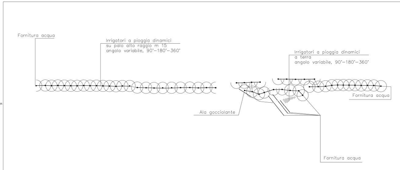
2 Schema di impianto d'irrigazione: planimetria
