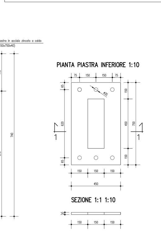
TIPOLOGICO TIRAFONDI M33 PER BARRIERE SU RILEVATO, H>= 700mm, CON Rck>=30 N/mm<sup>2</sup>
