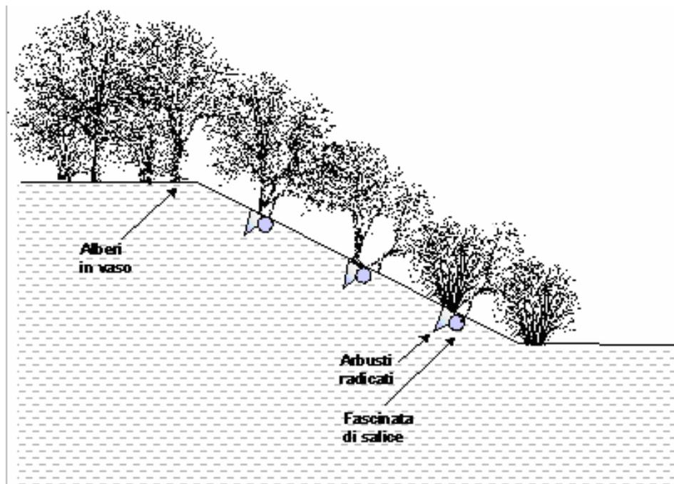
Fig. 10 – Sistemazione a verde della scarpata
