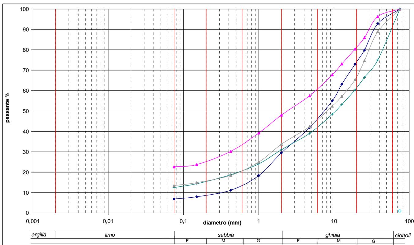
**Fig. 1 – Grafico riepilogativo delle analisi granulometriche effettuate su campioni prelevati dall'area BS3b**
