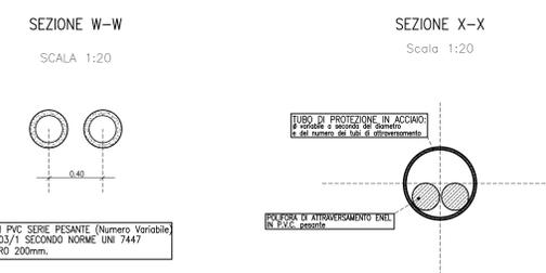
SEZIONE TIPO DI POSA CON SCAVO A CIELO APERTO
