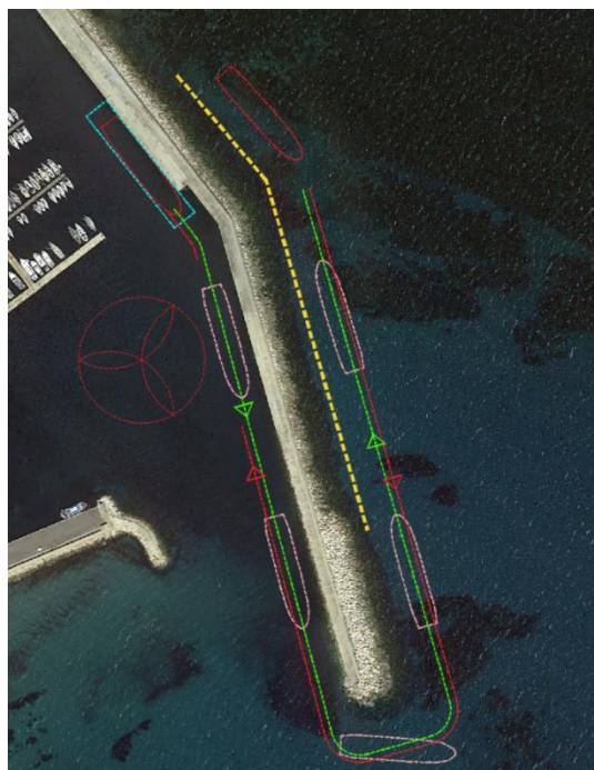
Figura 21: Indicazione delle manovre di ingresso e uscita della nave porta massi dal porto di La Caletta;
