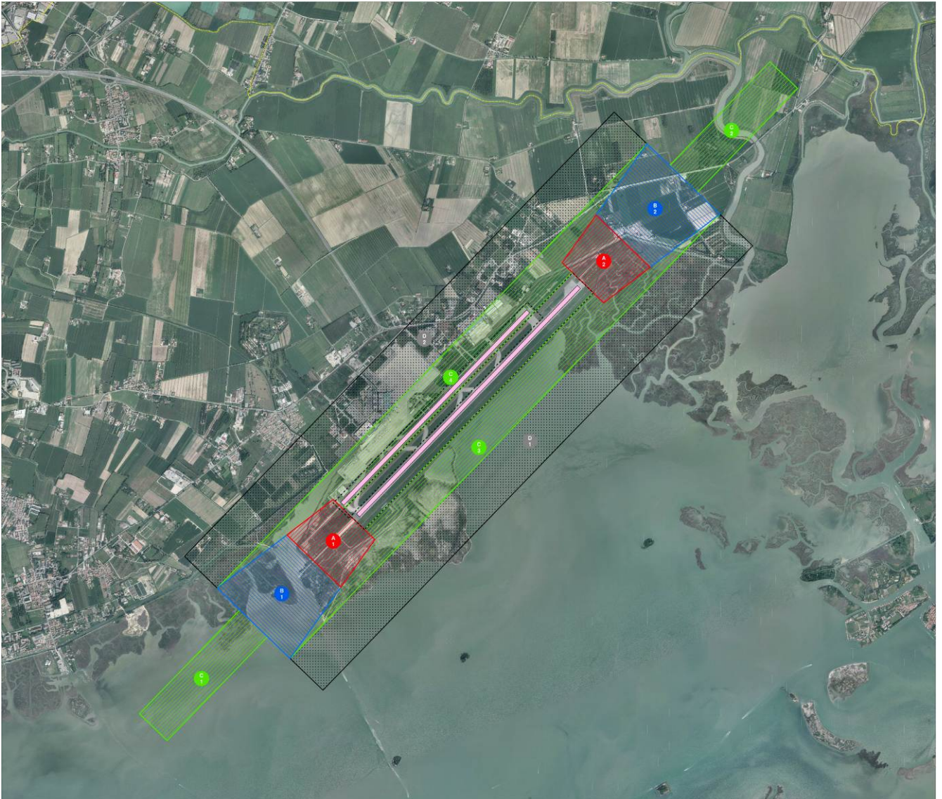
Figura A5-43 Piano di rischio del Comune di Venezia sovrapposto alla situazione urbanistica vigente (Fonte: Tavola P01 del Piano di Rischio Aeroportuale dell'aeroporto "Marco Polo" di Tessera-Venezia).
