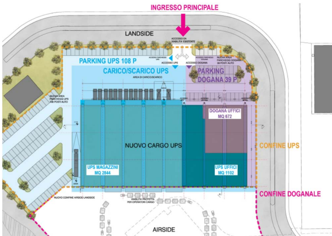
Figura B4-26 Riprotezione UPS e Dogana (codice 2.19) - studio di progetto, planimetria.
