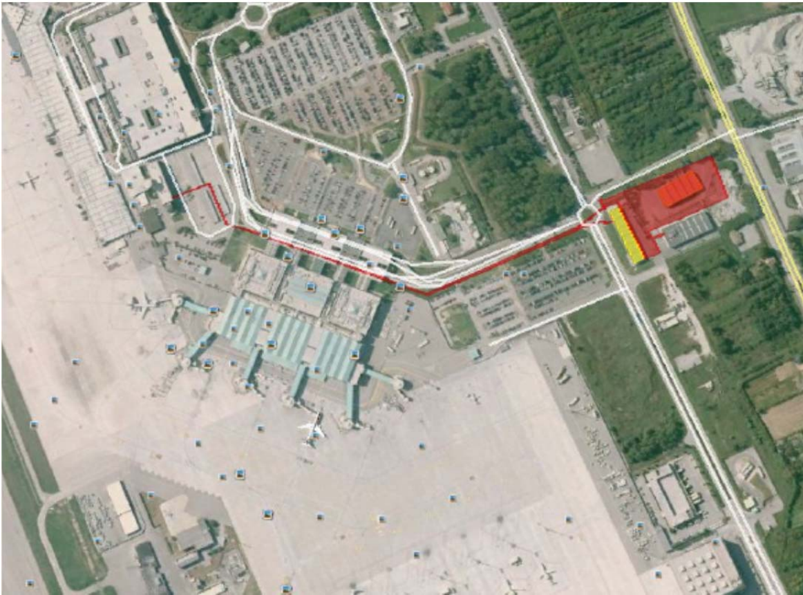
Figura B4-19 Nuova centrale trigenerazione e collegamenti relativi (codice 6.18) - la campitura rossa individua l'intera area di intervento, con gli edifici esistenti (giallo centrale termica attuale, arancione nuovo edificio trigenerazione), e il cunicolo tecnologico di servizio, interamente interrato sotto al piano stradale.
