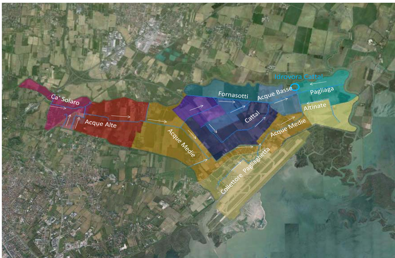
Figura C4-18 La rete di bonifica del bacino Cattal, a scolo meccanico, afferente all'omonima idrovora. Elaborazione in ambiente Google Earth con sfondo foto da satellite 2014.
