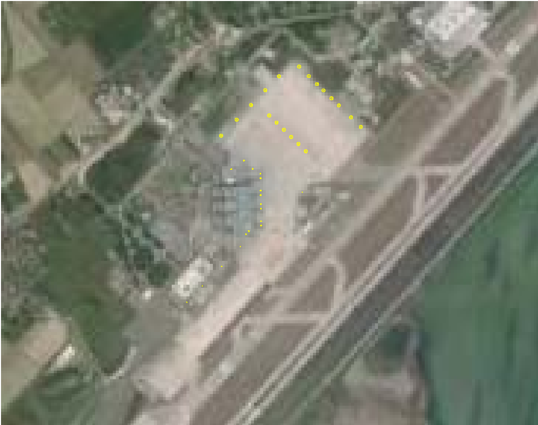
Figura C4-9 Posizionamento nel sedime delle torri faro dei terminali finger e del piazzale (punti in giallo).
