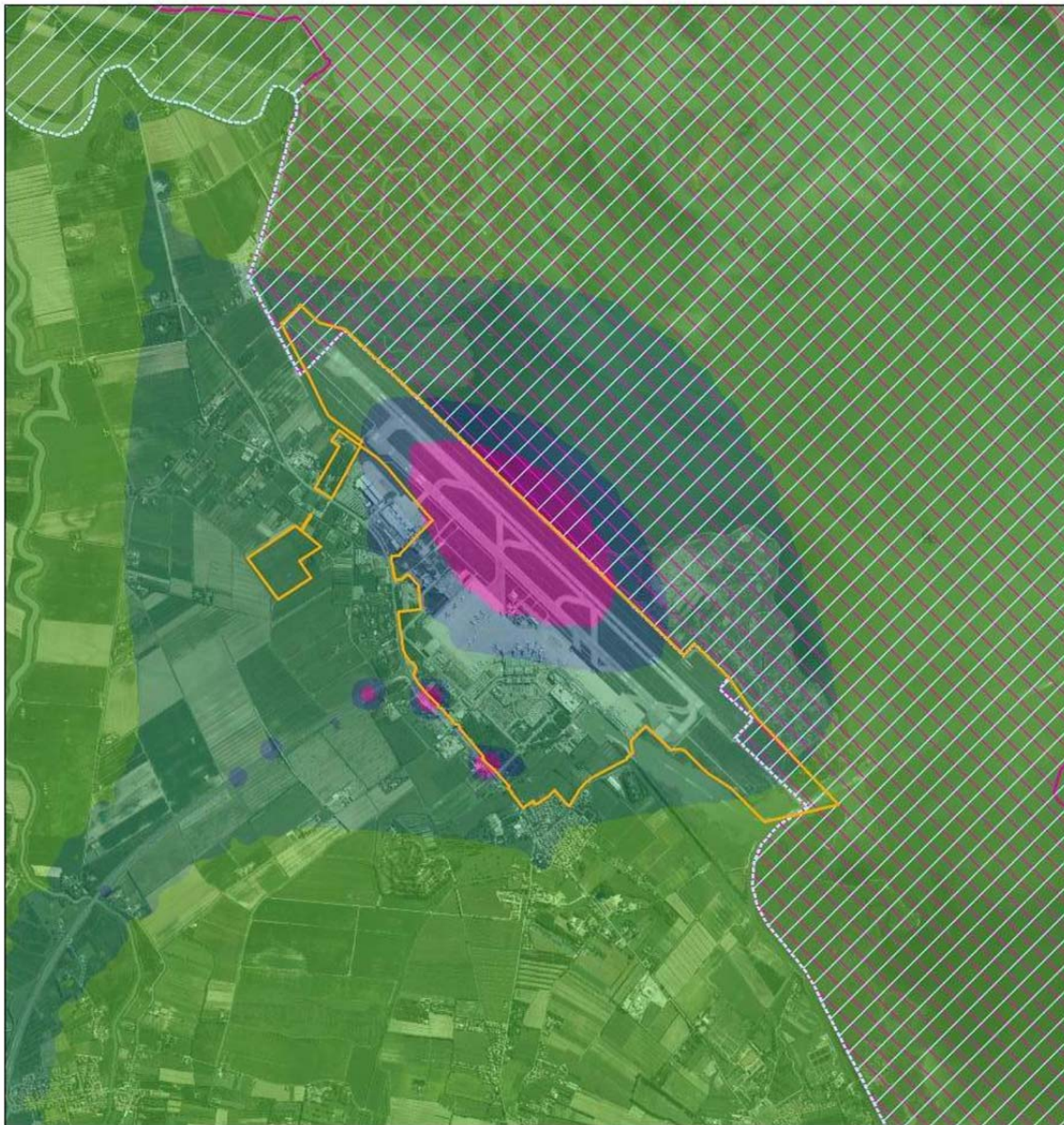
Figura C5-9 Concentrazioni medie di NOx nell'aria in µg/m 3 nel 2021 imputabili al traffico aereo e automobilistico.
