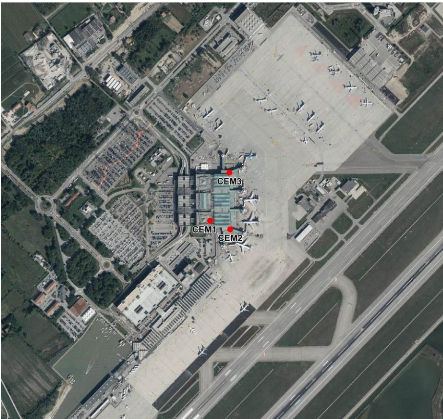
Figura D6-5 Postazioni di misura dei CEM nel terminal passeggeri (Fonte: SAVE S.p.A., http://ambiente.veniceairport.it/Home.aspx ).
