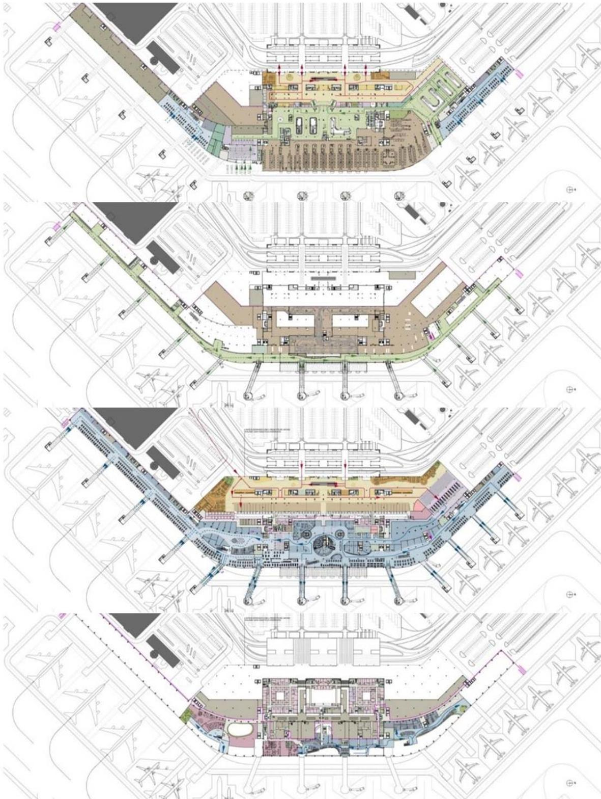
**Figura 3-26 Lotto 2 - Ampliamento terminal (codice 1.04) - Schemi funzionali, dall'alto: Piano terra, mezzanino, primo e secondo.**
