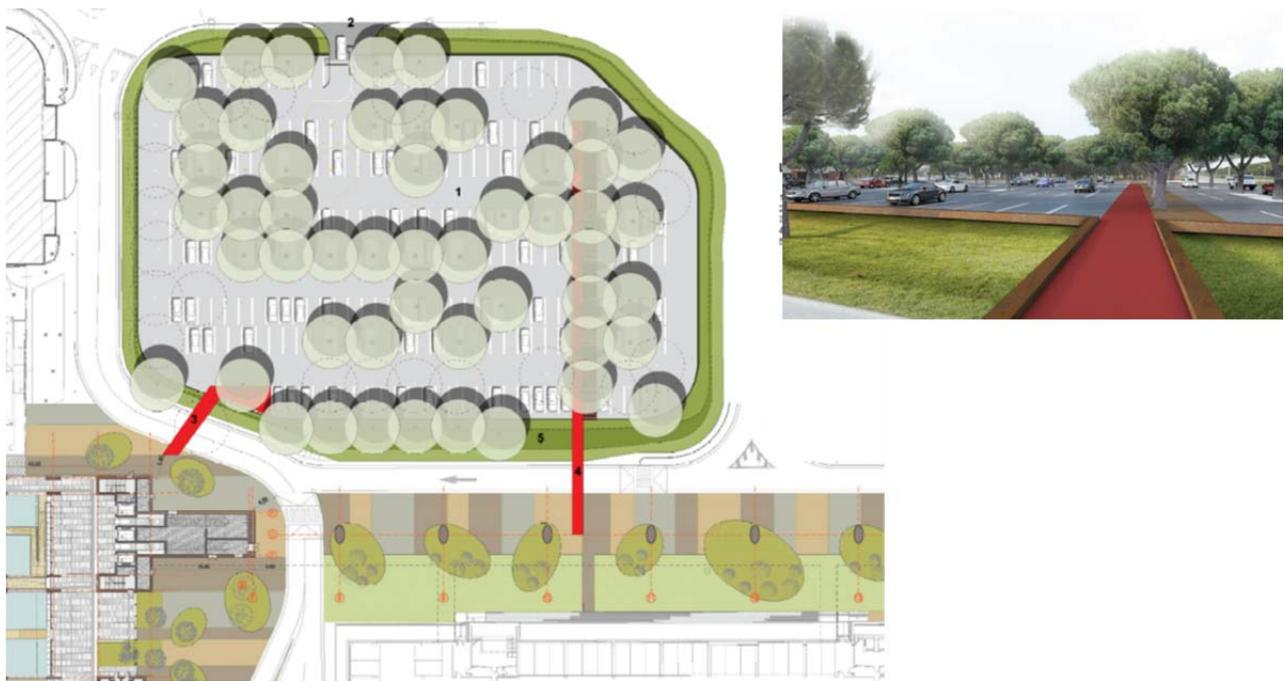
**Figura 3-22 Nuovo parcheggio "Moving walkway" – Planimetria e render (i tratti in rosso indicano i percorsi pedonali principali).**
