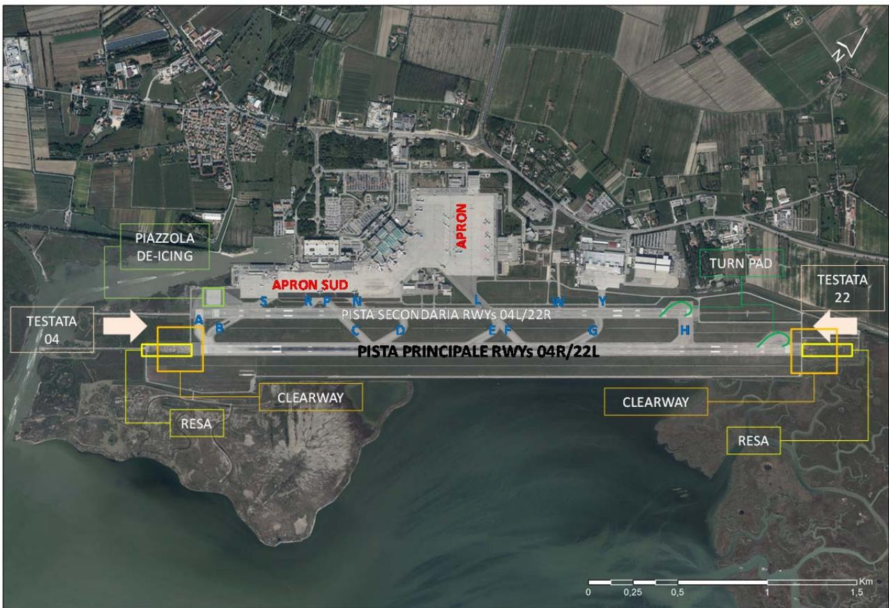
Figura 3-18 Layout delle infrastrutture di volo – stato attuale.
