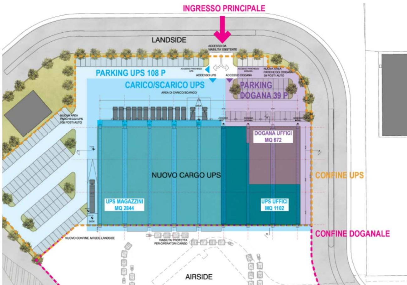
**Figura 3-30 Riprotezione UPS e Dogana (codice 2.19) - studio di progetto, planimetria.**
