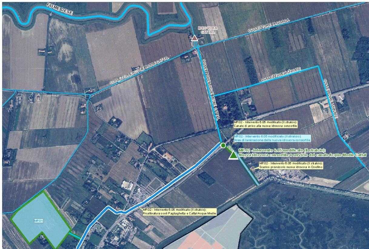
Figura 29. Interventi previsti dal Masterplan idraulico al 2021: completamento della ricalibratura del Canale Acque Medie Cattal, dall'Area di espansione MP.01 fino alla derivazione alla nuova idrovora consortile, e nuova idrovora del Consorzio Acque Risorgive e opere annesse.
