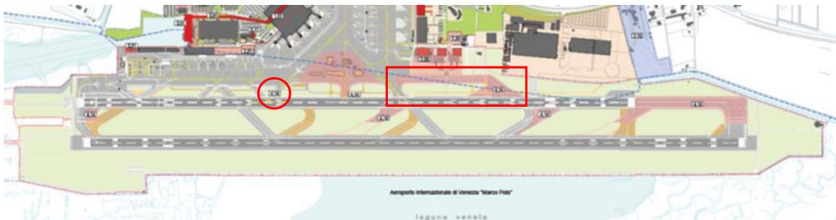
Figura 24. Configurazione airside al 2016: Interventi di demolizione e ricostruzione dei raccordi e della pista previsti nel Masterplan – Intervento 4.14 "Riqualfica e adeguamento normativo infrastrutture di volo".
