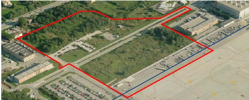
Figura 22. Area di intervento dell'ampliamento piazzali. In blu, il tracciato del collettore Pagliaghetta, con deflusso da sudovest a nordest.
