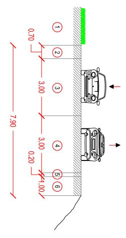
Stato di conservazione della pavimentazione: buono Stato di conservazione della segnaletica orizzontale: buono Larghezza media piattaforma = 7,90 m
