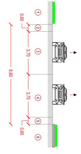
Stato di conservazione della pavimentazione: buono Stato di conservazione della segnaletica orizzontale: buono Larghezza media piattaforma = 8,60 m
