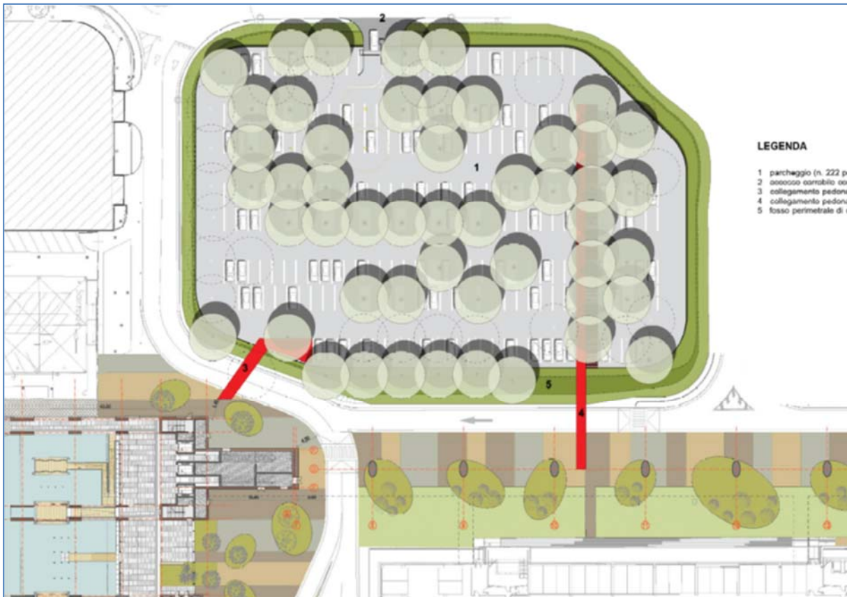
Parcheggio MW – planimetria – i tratti in rosso indicano i percorsi pedonale principali
