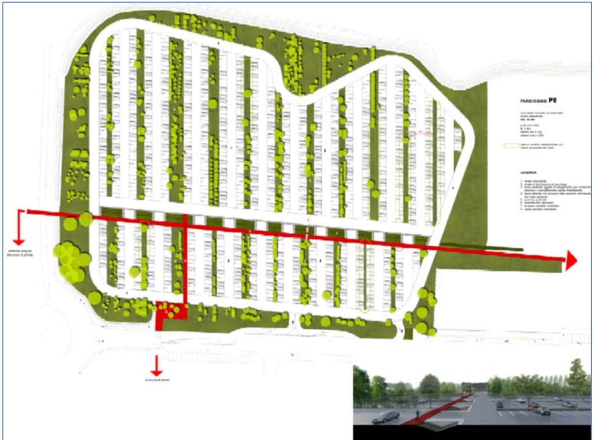
Parceggio P6 – planimetria – i tratti in rosso indicano i percorsi pedonale principali
