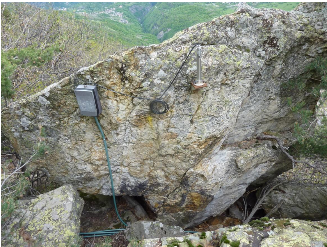
Fig. 7 – Clinometro (rete monitoraggio della Musinet).
