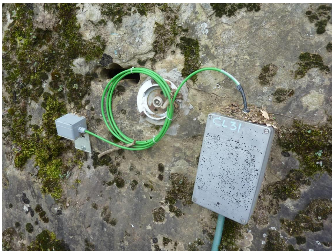
Fig. 8 – Estensimetro a basi (rete monitoraggio della Musinet).
