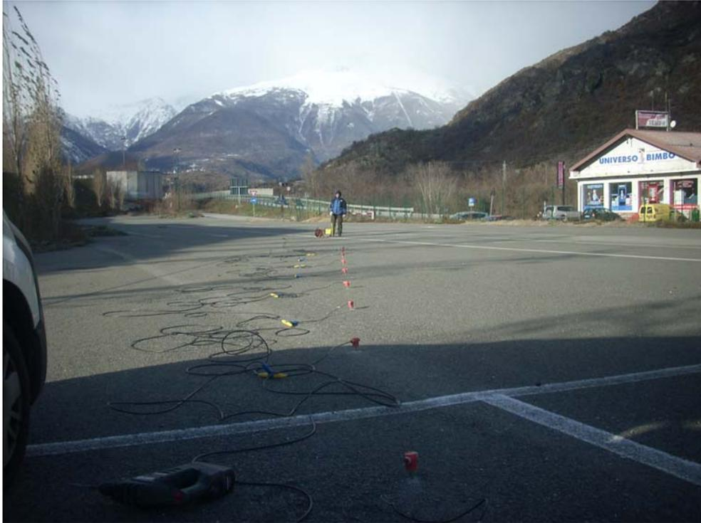
**Figura 1.** Stendimento di geofoni verticali
