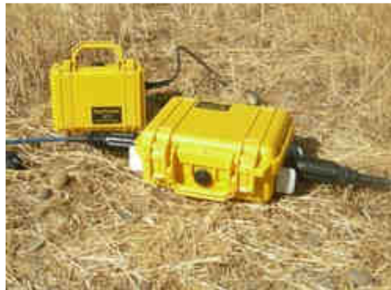
Figura 8: Unità d'acquisizione del sismografo Seistronic
