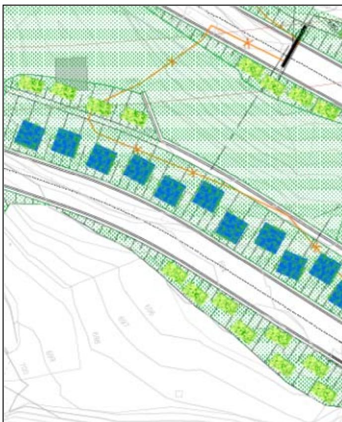
Figura 25 – INGRANDIMENTO 3: inerbimento e piantumazione di arbusti sulle scarpate della strada di accesso al cantiere
