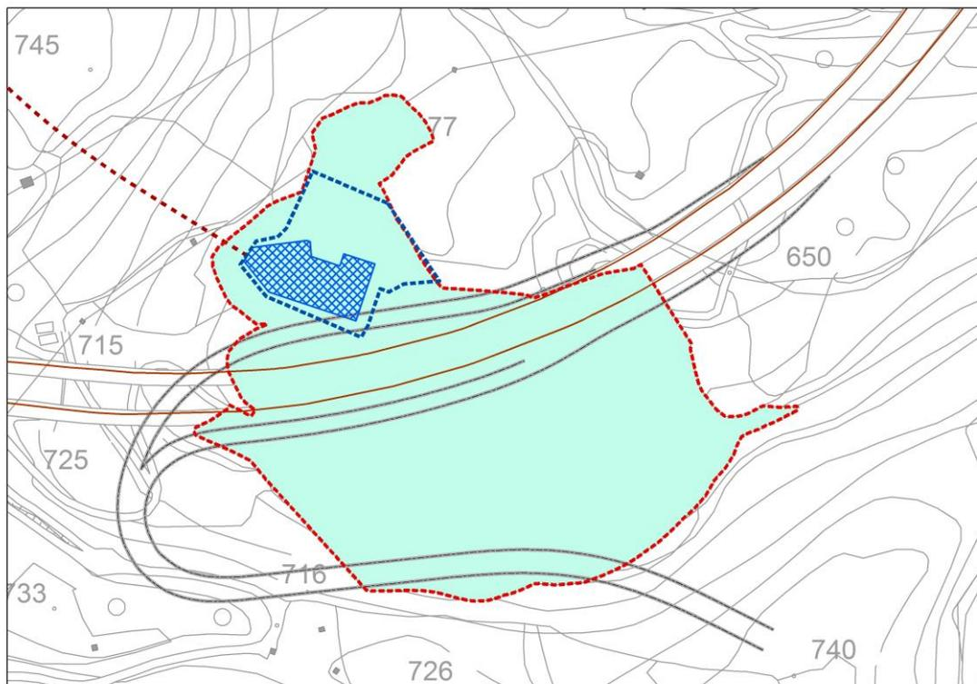
**Figura 6** – Stralcio relativo alle superfici interferite durante le attività presso il cantiere dell'Imbocco di Maddalena
