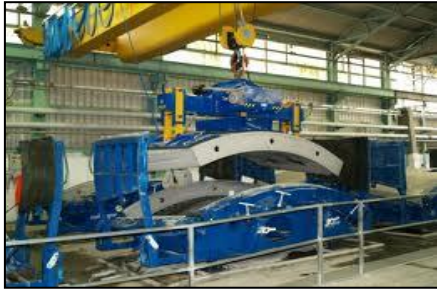
Figura 12 – Impianto di prefabbricazione dei conci
