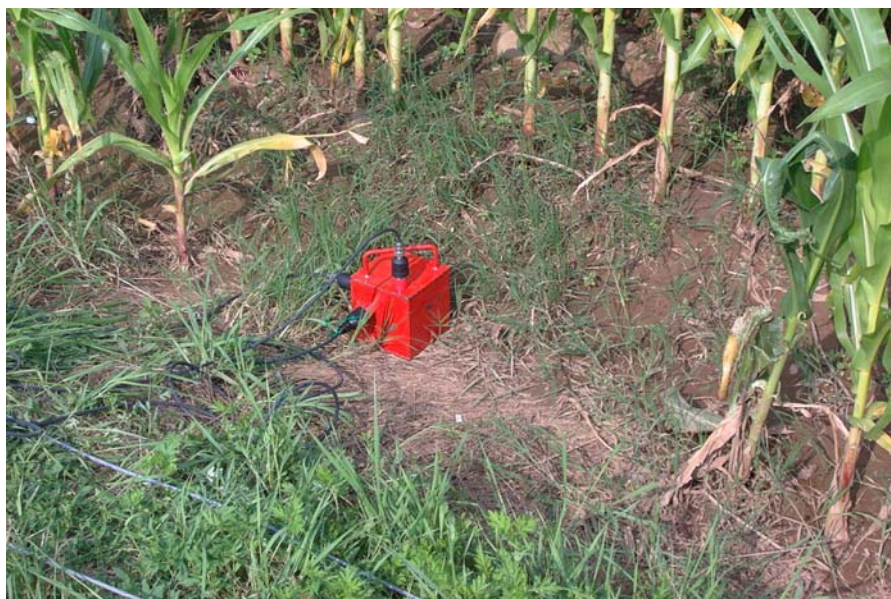
Figura 37 Postazione di misura a margine della linea ferroviaria Milano – Verona – posizione d=24 m
