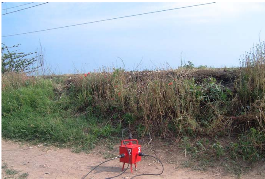
Figura 36 Postazione di misura a margine della linea ferroviaria Milano – Verona – posizione d=6 m
