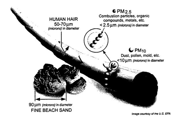
Nella figura i diametri delle polveri sottili (PM) sono messi a confronto con le dimensioni di
