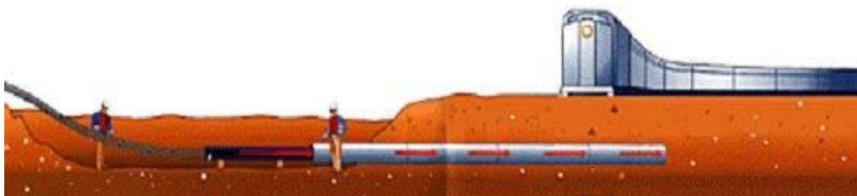
Figura 2.5-8: Esempio di attraversamento con spingitubo
