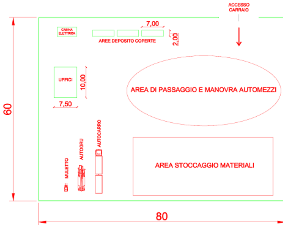
Figura 3.4-21: Planimetria dell'area centrale di cantiere - misure indicative
