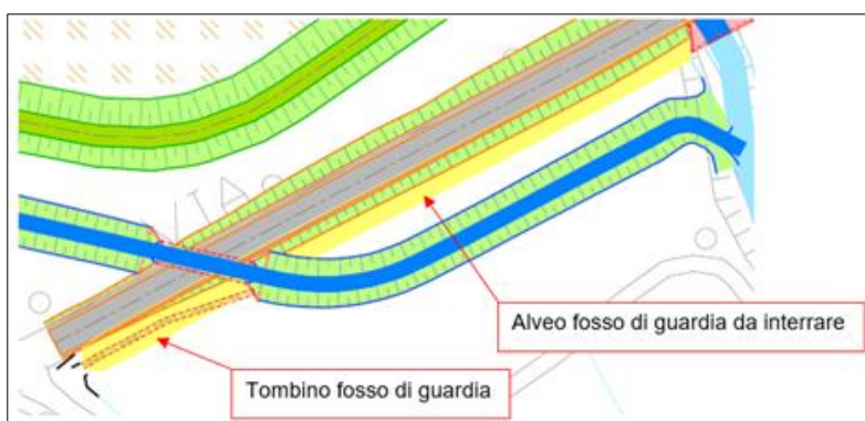
Figura 4-15 Estratto planimetrico del tombino a sud di Via Vigo
