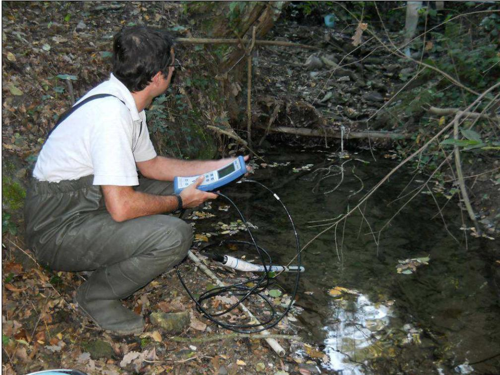
**Foto 2 – Misurazione dei parametri chimico-fisici in situ con sonda multiparametrica nella stazione T-GE-510 del Rio Costiera (Ottobre 2013)**
