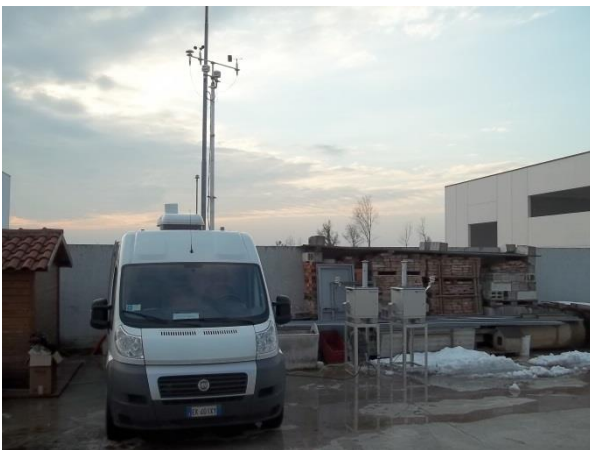
Figure 3.1 - Allestimento Laboratorio Mobile – Analizzatori e Campionatori Sequenziali
