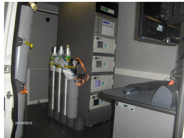
Figure 3.1 - Allestimento Laboratorio Mobile – Analizzatori e Campionatori Sequenziali
