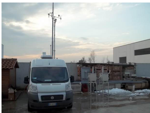
Figure 3.1 - Allestimento Laboratorio Mobile – Analizzatori e Campionatori Sequenziali
