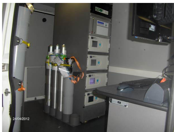
Figure 3.1 - Allestimento Laboratorio Mobile – Analizzatori e Campionatori Sequenziali
