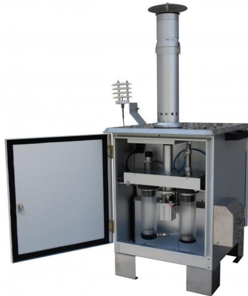
Figure 4.1 - Skypost Hv utilizzato per il monitoraggio delle PM10
