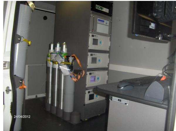
Figure 3.1 - Allestimento Laboratorio Mobile – Analizzatori e Campionatori Sequenziali
