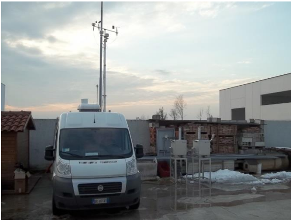
Figure 3.1 - Allestimento Laboratorio Mobile – Analizzatori e Campionatori Sequenziali
