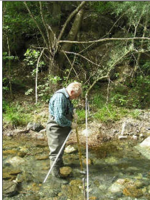
Foto 2 – Misura delle portate sul Torrente Verde nella stazione T-CM-050 (Maggio 2014)
