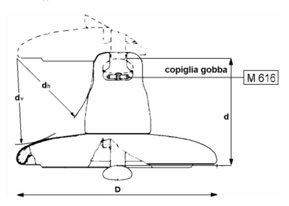
Le caratteristiche geometriche di cui sopra sono sufficienti a garantire il corretto comportamento delle catene di isolatori a sollecitazioni impulsive dovute a fulminazione o a sovratensioni di manovra.
