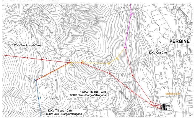
Il tratto di elettrodotto della linea 60KV Trento Ponte San Giorgio-Borgovalsugana dal sostegno n° 35 al sostegno n° 40 viene completamente demolito.
