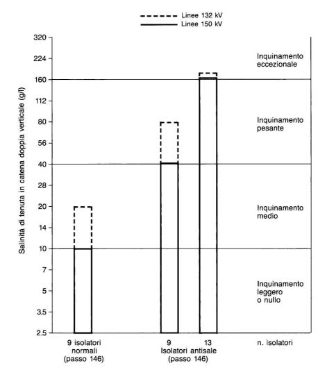
Per le linee che attraversano zone con inquinamento nullo o leggero si impiegano catene composte da 9 elementi di tipo 'noprmale'.
