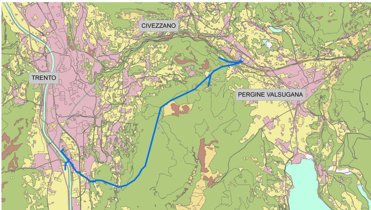
Figura 5.12 – Percorso dell'elettrodotto 132 KV Cirè – Trento sud
