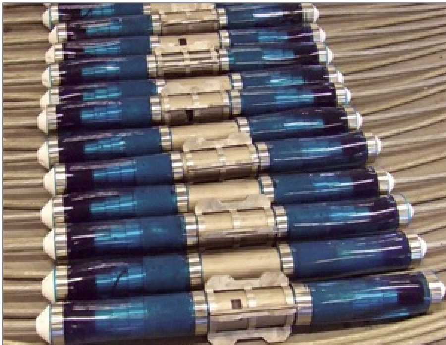
Figura 2.8 – Serie di idrofoni usati per l'acquisizione del segnale off-shore (fonte: www.oilonline.com )
