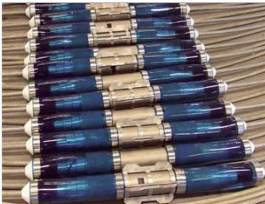
Figura 3.11 – Serie di idrofoni usati per l'acquisizione del segnale off-shore (fonte: [www.oilonline.com](http://www.oilonline.com))
