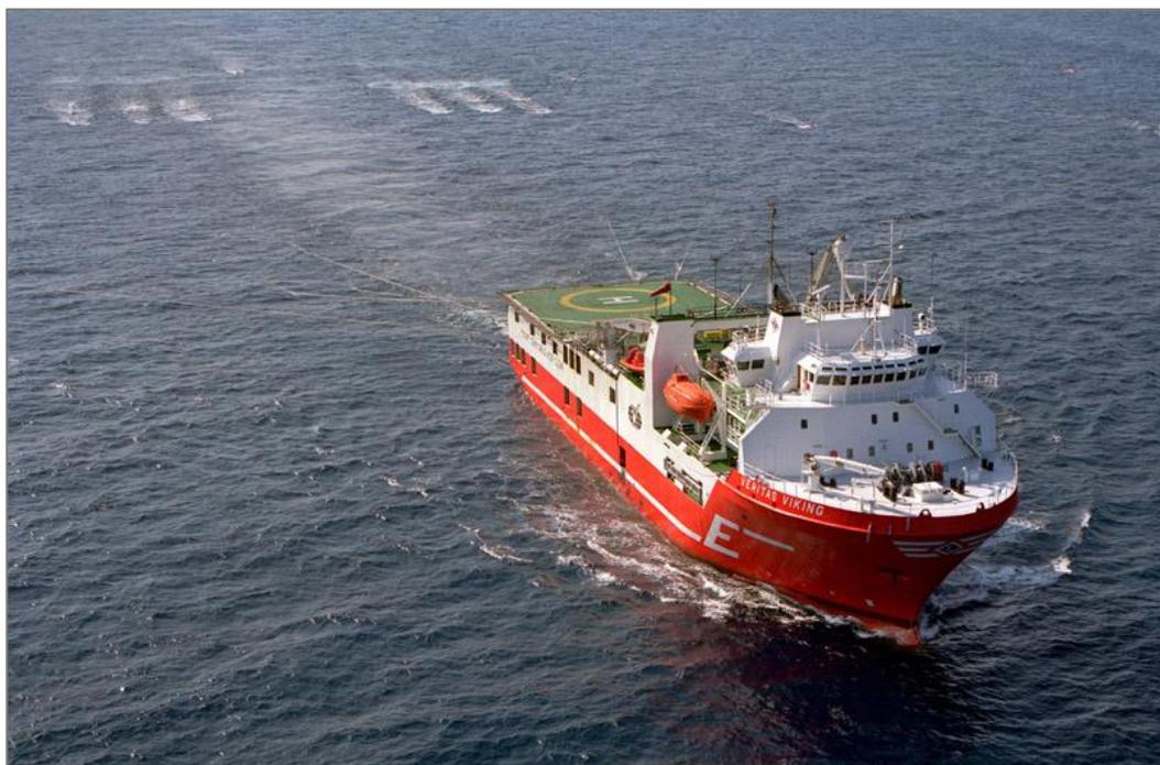
Figura 2.11 – Esempio di nave per acquisizione sismica durante l’acquisizione (fonte: [www.gas-naturale.ch/gas-naturale/estrazione](http://www.gas-naturale.ch/gas-naturale/estrazione)).
