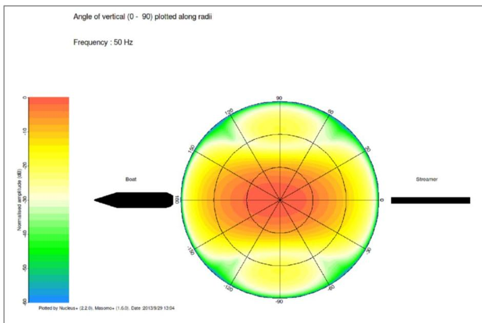
Figura 2.14 – Modello in pianta raffigurante l'emissione di energia in un raggio di 360° intorno ad un *array* di *air-gun*, secondo la configurazione *array* 3. In nero è indicata la direzione di movimento della nave
