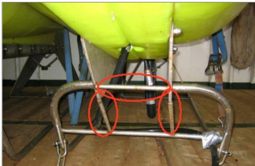
Figura 6.2 Le barre metalliche (evidenziate dal cerchio in rosso) studiate appositamente per non far oltrepassare i corpi delle tartarughe ed eventualmente per scostarle dalla rotta della boa di coda.
