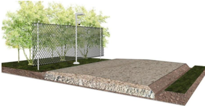
Figura 18. Recinzione perimetrale e pista di impianto
