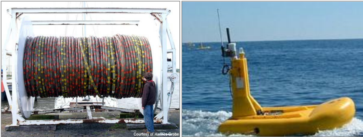
Figura 2.7 – Streamer o cavo sismico per l'acquisizione a sinistra (fonte: www.offshore-technology.com/features/feature43561/feature43561-3.html ) e boa di coda a destra (fonte: www.seamap.com )
