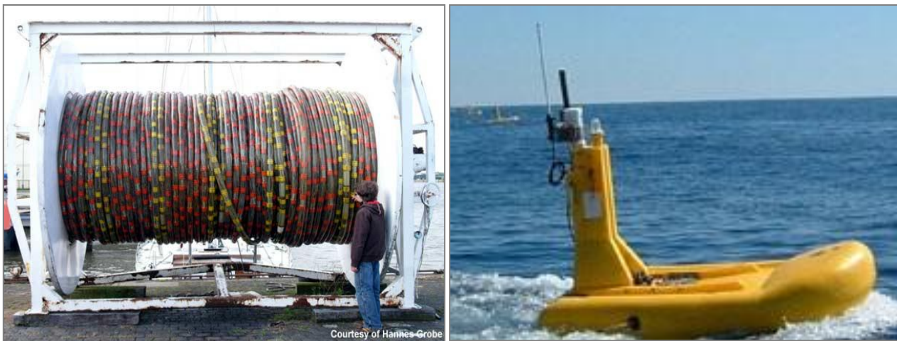
Figura 3.12 – Streamer o cavo sismico per l'acquisizione a sinistra (fonte: www.off-shore-technology.com/features/feature43561/feature43561-3.html ) e boa di coda a destra (fonte: www.seamap.com )
