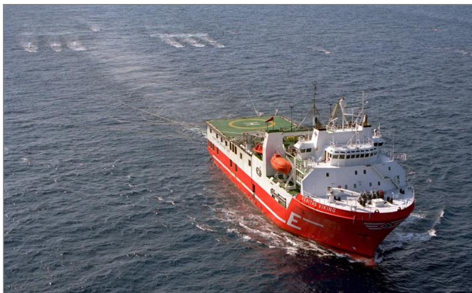
Figura 3.16 – Esempio di nave per acquisizione sismica durante l’acquisizione (fonte: www.gas-naturale.ch/gas-naturale/estrazione )
