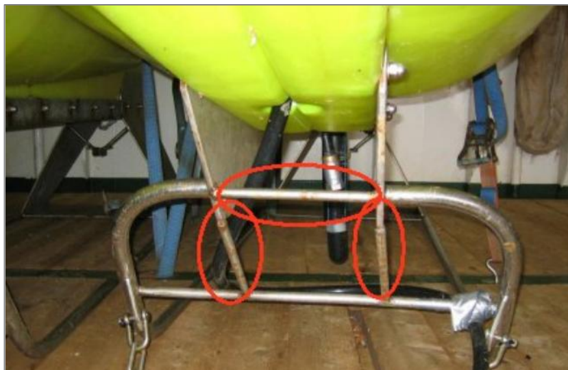
Figura 6.3 Le barre metalliche (evidenziate dal cerchio in rosso) studiate appositamente per non far oltrepassare i corpi delle tartarughe ed eventualmente per scostarle dalla rotta della boa di coda.
